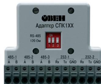
Рис. 1. Корпус адаптера СПК1xx.
