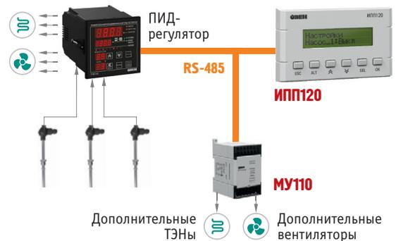
Рис. 2. Управление режимами сушки (задача 3)
