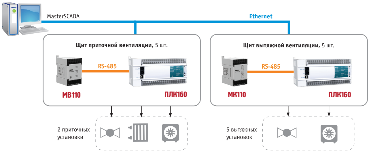
Рис. 1. Функциональная схема управления приточной вентиляцией
