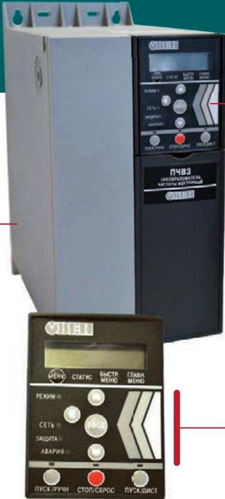
Съёмная локальная панель оператора ЛПОЗ предназначена для программирования и индикации значений параметров работы ПЧВЗ. Запрограммированный прибор может функционировать без ЛПОЗ, поэтому партия из нескольких приборов может комплектоваться одной ЛПОЗ. ЛПОЗ поставляется по отдельному заказу.
