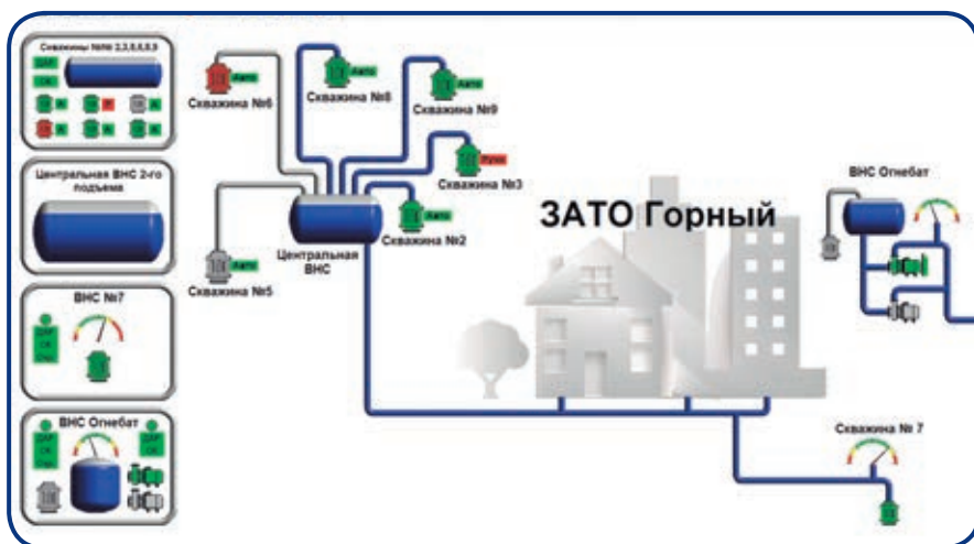
Рис. 1. Общая мнемосхема всех ВНС
