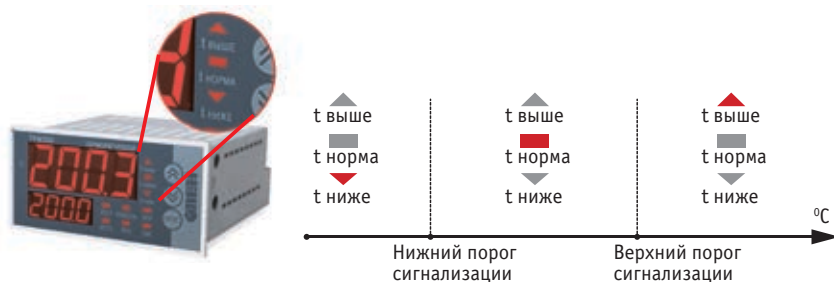
Рис. 5. Индикация нахождения текущей температуры в допустимой или критической зонах
