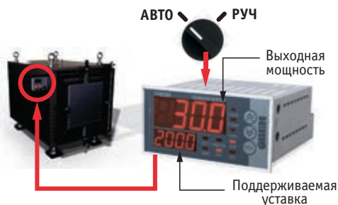
Рис. 2. Дискретный вход для перехода в ручной режим управления выходной мощностью
