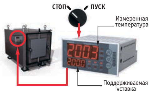
Рис. 1. Дискретный вход для пуска/остановки автоматического управления температурой
