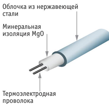
Рис. 3. Конструкция на основе КТМС
