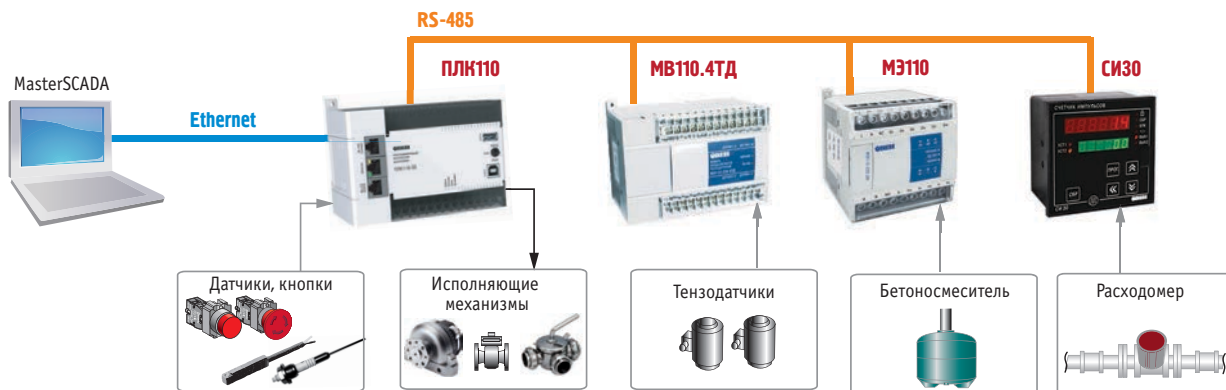
Рис. 1. Функциональная схема управления бетономесительным комплексом
