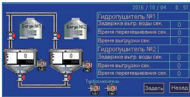
Рис. 2. Окно управления гидропушителями
