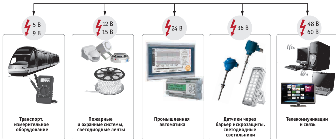
Рис. 3. Применения источников питания ОВЕН в зависимости от выходного напряжения в различных отраслях
