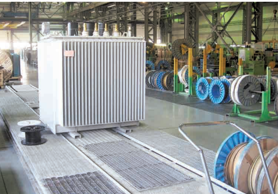
Фото 1. Участок заливки трансформаторов
