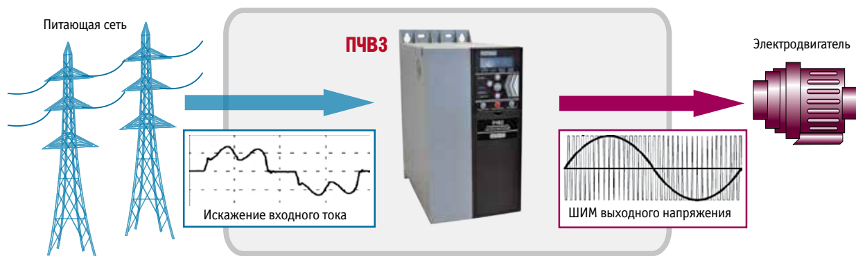
Рис. 1. Входное и выходное напряжение частотного преобразователя
