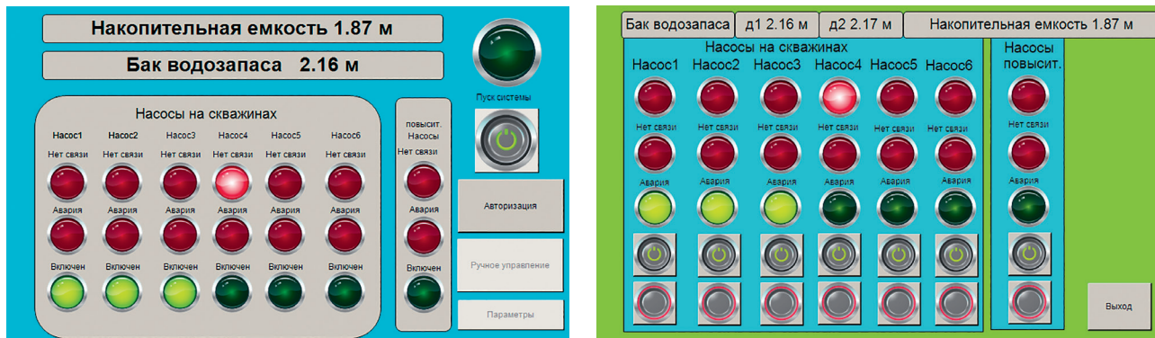
Рис. 2. Мнемосхемы состояния исполнительных механизмов
