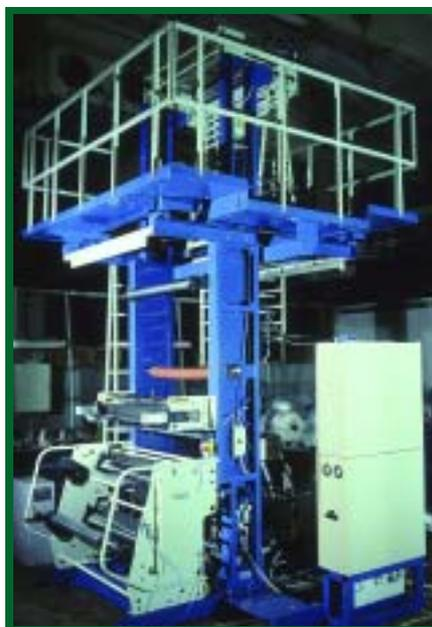
участками, то для оценки прочности пленки с номинальной толщиной 100 микрон и разнотолщинностью 20 % надо ориентироваться на ее участки толщиной в 80 мкм. В этом случае коэффициент использования материала на 10–20 % ниже того, который можно получить на современных пленочных экструдерах. Говоря иными словами, большая разнотолщинность пленки ведет к перерасходу сырья и снижает рентабельность производства, работающего на старых моделях пленочных экструдеров.
