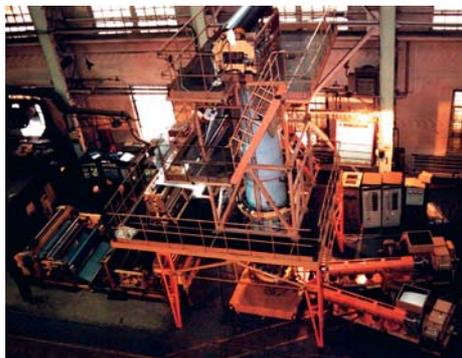
пленок, наполненных двуокисью титана, сажей и различными модифицирующими добавками, которые применяются для производства упаковок, необходимых для молока, соков и других пищевых продуктов. В составе линии был опробован ряд новых узлов, повышающих функциональные возможности линии: дозирующее устройство, фильтр с быстрой сменой фильтрующих элементов, двухкамерная реверсивная формующая головка с внутренним охлаждением, автоматический намотчик рулонов новой конструкции.
