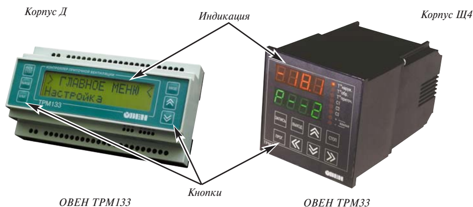
Рис. 1. Конструктивные отличия контроллеров ОВЕН ТРМ 133 и ОВЕН ТРМ33
