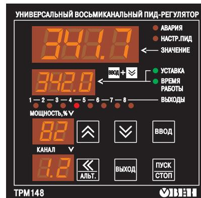
Рис. 1. Передняя панель универсального восьмиканального ПИД-регулятора ТРМ148
