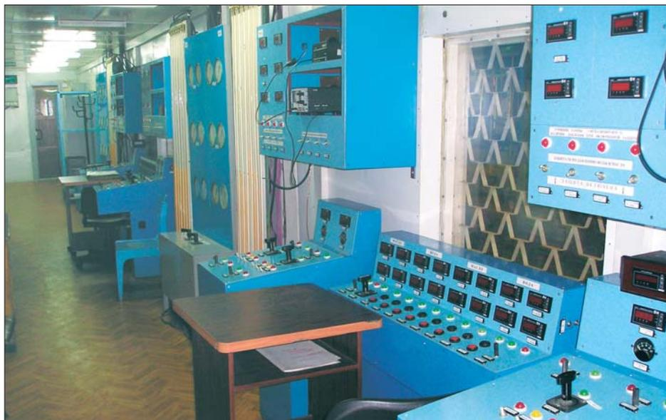
*Фото 2. Стенд для тестирования и наладки компрессоров, монтируемый в «Специальном конструкторском бюро турбоагнетателей» (работы ведутся при содействии компании «ТДА-Электро»). Приборы ОВЕН 2ТРМ1А измеряют температурные режимы охлаждающей жидкости, масла в компрессоре, газов за турбиной, воздуха перед компрессором и за компрессором*
