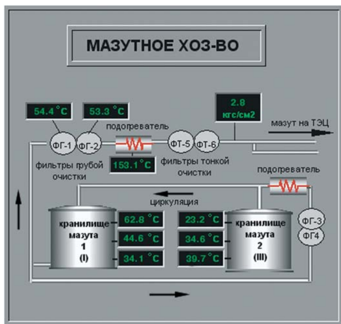
Рис. 1. Мнемосхема мазутного хозяйства
