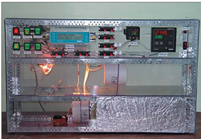
Фото 2. Приточно-вытяжная вентиляционная установка, созданная в АГТУ в 2006 году
