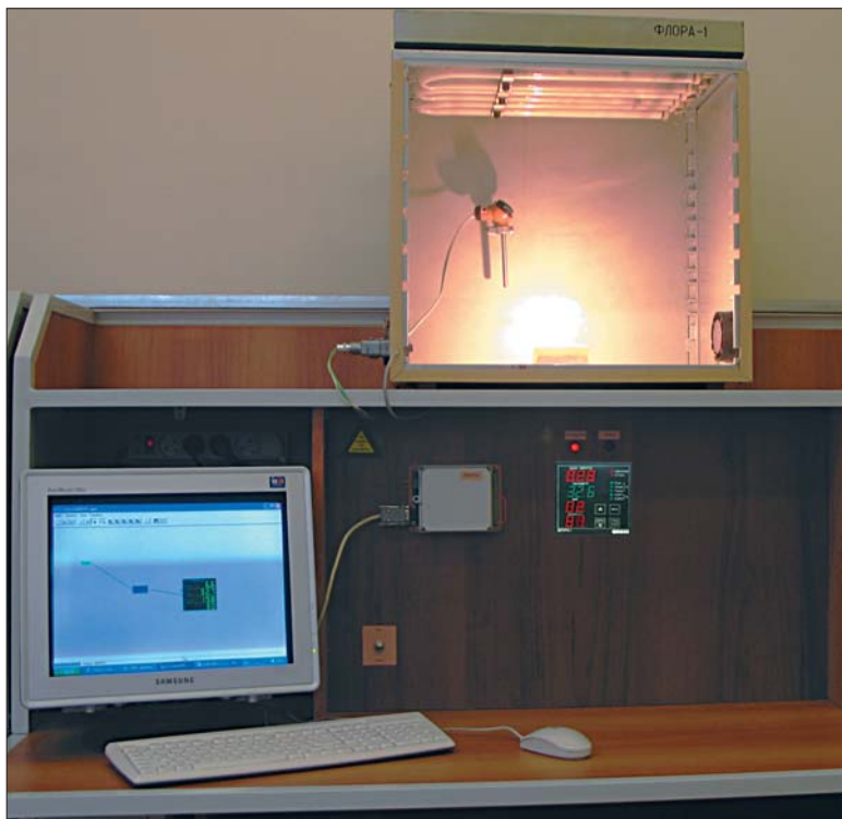
Фото 1. Лабораторная установка на основе ОВЕН МПП51, созданная на кафедре автоматике Агроинженерного университета
