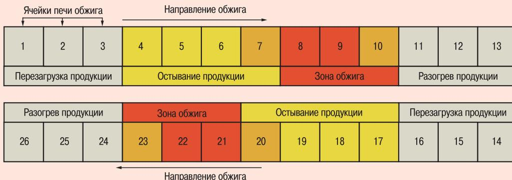
Рис. 4. Схема обжиговой печи и процесса обжига
