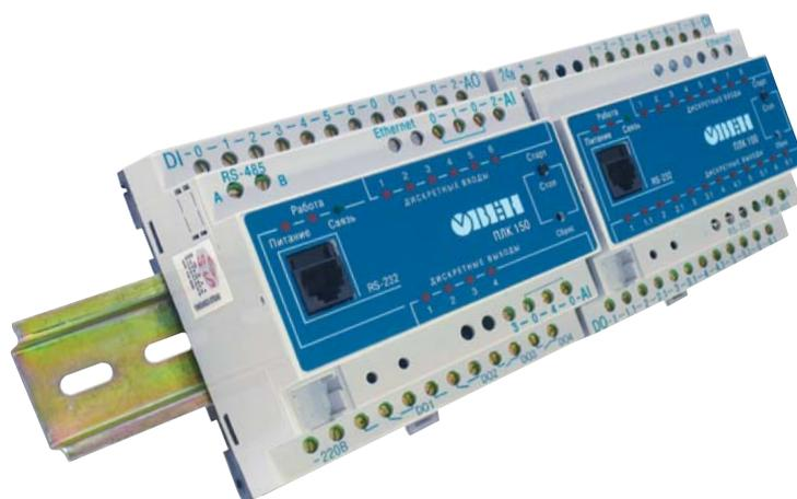
После того, как всё необходимое оборудование описано в окне *PLC Configuration*, контроллер автоматически распознает конфигурацию и включает необходимые драйверы. После этого всё периферийное оборудование готово к работе и данные с него могут быть использованы пользовательской программой. Внутри самой программы никаких настроек оборудования не требуется.
