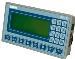
Версия **6.4f** обеспечивает работу панели по протоколу Modbus RTU в режиме *slave*.
